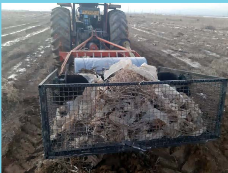
دستگاه جمع کن خودکار مالچ پلاستیکی نازک تولید شده توسط شرکت آتیه طراح ماشین تارا
